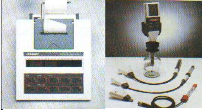
جهاز قياس pH والحلوة والأوكسجين والايونات الذائبة
